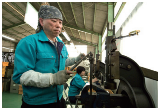
技を極めた職人が、ハンドワークで特注のばねを作る
